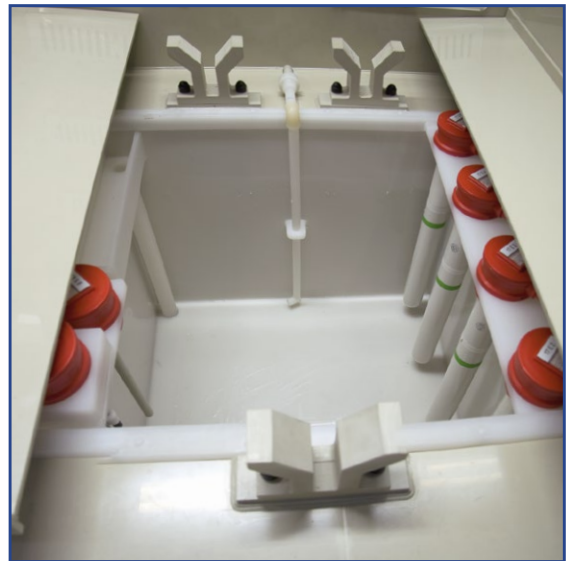
Spüle mit eingebauten Sicherheitstemperaturbadwärmern
